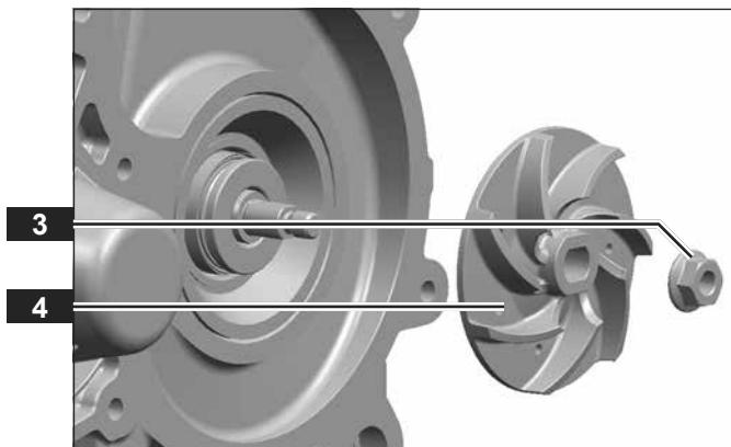
050.02.02 Installing impeller
