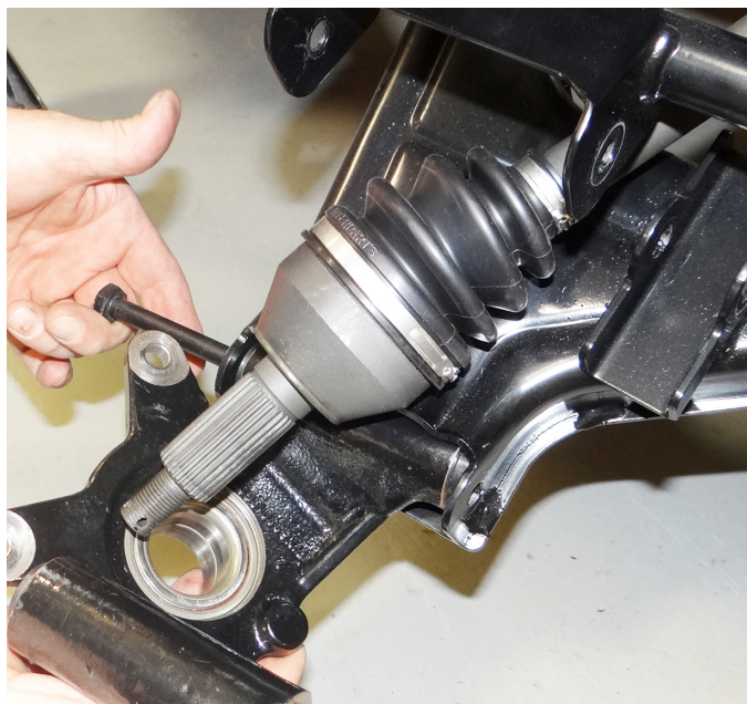
Fig. 6 Remove Spindle
